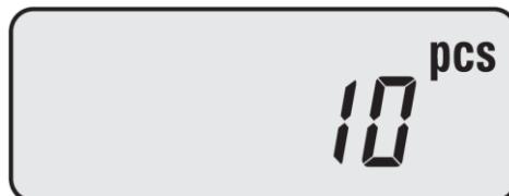
Vložte na vážící misku zvolený referenční vzorek (minimálně 10ks počítaných součástek) a potvrďte tlačítkem
