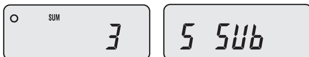
Vynulování součtové paměti se pak provede tlačítkem ve chvíli zobrazení součtu navážek na displeji
