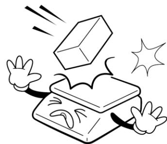
Nepřetěžujte vaši váhu nad její deklarovanou maximální váživost. Při přetížení by mohlo dojít ke zničení snímače zatížení ve váze.
