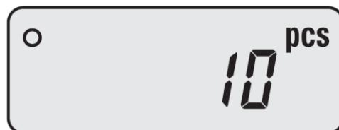
Po přidávání nebo ubírání počítaných součástek displej dále přímo ukazuje aktuální počet součástek vložený na vážící misku (například 50ks)
