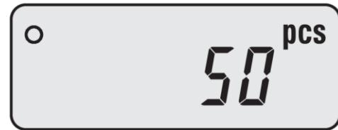
V případě, že je vzhledem k dané váživosti (a tedy schopnosti rozlišení) dané váhy je vložený referenční vzorek příliš malý, respektive jednotková hmotnost vložených součástek příliš nízká, váha toto indikuje hláškou dle následující tabulky.
