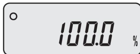
Po přidávání nebo ubírání zátěže displej dále přímo ukazuje aktuální % zátěže, vložené na vážicí misku, v porovnání s vloženým referenčním vzorkem, který je považován za 100% (například 125%)
